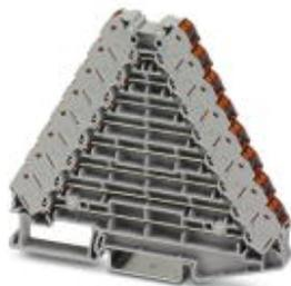
Распределительная панель, номинальное напряжение: 250 В, номинальный ток: 8 А, сечение: 0,14 мм<sup>2</sup> - 2,5 мм<sup>2</sup>, AWG: 14 - 26, тип подключения: Зажимы Push-in, полюсов: 2, количество подключений: 32, ширина: 8,3 мм, длина: 100 мм, цвет: серый, цвет элементов подключения: красный, монтаж: NS 35/7,5, NS 35/15
