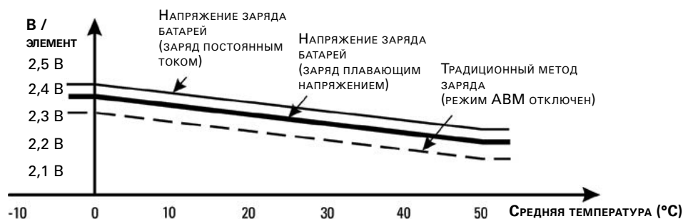
Температурная компенсация. Зависимость напряжения заряда от температуры.
