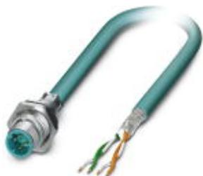
Встраиваемый разъем (вилка) шинной системы, Ethernet, 4-полюсный, M12-SPEEDCON, экранированный, с механическим ключом D-типа, монтаж с задней части стенки / резьбовое крепление Pg9, с кабелем шины длиной 2,0 м, 2 x 2 x 0,2 мм<sup>2</sup>
