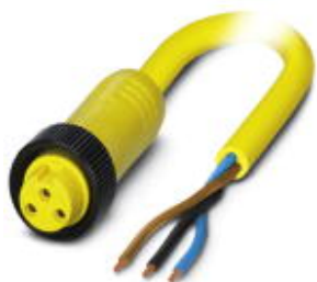
Силовой кабель, 3-полюсн., ПВХ, желтый, свободный конец, А - стандарт, к Гнездо прямое 7/8"-16UNF, длина кабеля: 10 м
