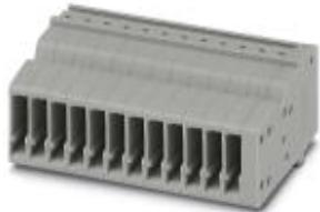
Соединитель COMBI, номинальное напряжение: 500 В, номинальный ток: 17,5 А, тип подключения: Зажимы Push-in, количество точек подсоединения: 1, полюсов: 12, сечение: 0,14 мм<sup>2</sup> - 1,5 мм<sup>2</sup>, AWG: 26 - 14, ширина: 42 мм, высота: 17,8 мм, цвет: серый
