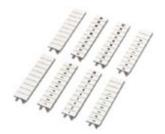
Планка Zack, Полоса, белый, с маркировкой, надписи вдоль: нумерация по порядку, тип монтажа: крепление в высоких пазах для табличек, для клемм шириной: 5,2 мм, размер маркировочного поля: 10,5 x 5,15 мм
