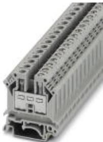
Проходные клеммы, с винтами для крепления контрольного штекера справа, номинальное напряжение: 500 В, номинальный ток: 57 А, тип подключения: Винтовые зажимы, количество точек подсоединения: 2, сечение: 0,5 мм<sup>2</sup> - 10 мм<sup>2</sup>, AWG: 20 - 8, ширина: 8,2 мм, цвет: серый, тип монтажа: NS 32, NS 35/7,5, NS 35/15
