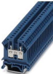
Проходные клеммы, номинальное напряжение: 800 В, номинальный ток: 32 А, тип подключения: Винтовые зажимы, количество точек подсоединения: 2, сечение: 0,2 мм<sup>2</sup> - 4 мм<sup>2</sup>, AWG: 24 - 12, ширина: 6,2 мм, цвет: синий, тип монтажа: NS 35/7,5, NS 35/15, NS 32
