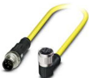
Кабель для датчика / исполнительного элемента, 4-полюсн., ПВХ, желтый, Штекеры прямое M12 SPEEDCON, А-кодирование, к Гнездо угловой M12 SPEEDCON, А-кодирование, длина кабеля: 5 м
