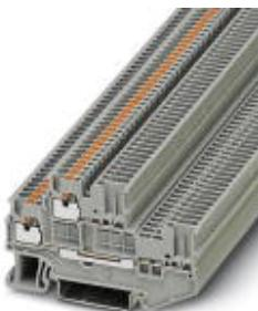
Двухъярусные клеммы, тип подключения: Разъемное подключение / Push-in, сечение: 0,14 мм<sup>2</sup> - 1,5 мм<sup>2</sup>, AWG: 26 - 14, ширина: 3,5 мм, цвет: серый, тип монтажа: NS 35/7,5, NS 35/15
