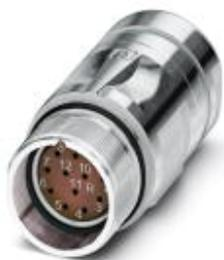
Переходной соединитель, прямой, экранирован.: есть, для стандартной блокировки и SPEEDCON, M23, Полюсов: 12, тип контактов: Розетка, Обжим, диапазон диаметра кабеля: 10 мм ... 14,5 мм
