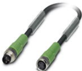
Кабель для датчика / исполнительного элемента, 3-полюсн., PUR без галогенов, темно-серый RAL 7021, Штекеры прямое M8, к Гнездо прямое M8, длина кабеля: 5 м
