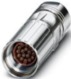
Кабельный соединитель, прямой, Винтовой зажим, M17, полюсов: 8, тип контактов: Розетка, Обжим, экранирован.: есть, диапазон диаметра кабеля: 5 мм ... 8 мм
