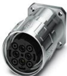
Приборный соединитель, передняя часть стенки, с накатанной гайкой, прямой, Крепление SPEEDCON, M40, полюсов: 2+3+PE, тип контактов: Розетка, Обжим, Аксиальное уплотнительное кольцо, 4x Ø4,2, экранирован.: есть, размер фланца: 40 мм x 40 мм
