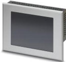
Сенсорная панель с 14,5 см / 5,7", FSTN-дисплей (аналого-резистивные (полиэфир)), 320 x 240 Пиксел (QVGA), 256 градаций серого, Arm9™, 200 МГц, 2x USB Host 2.0, 1x Ethernet (10/100 Мбит/с), RJ45, Windows CE 5.0 и прикладное ПО: TSvisRT. (шинная система: MPI)
