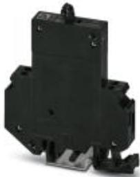
Автоматические выключатели с тепловыми и электромагнитными расцепителями, 1-полюсные, полуинертного типа, 1 замыкающий контакт, с универсальными монтажными ножками для установки на NS 32 или NS 35
