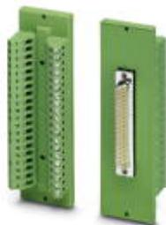
Проходной модуль VARIOFACE для непосредственного подсоединения отдельных сигнальных проводников с сечением до 2,5 мм<sup>2</sup>, со штыревым миниразъемом D-SUB (без крепежных винтов), количество контактов 37
