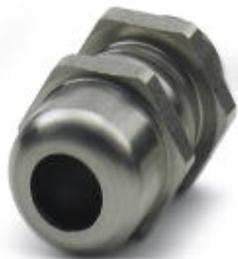
Кабельный ввод, материал резьбового соединения: Нержавеющая сталь 1.4305, наружный диаметр кабеля 3 мм ... 6,5 мм, экранировка: нет, резьба соединительной части: M12 x 1,5, цвет: серебристый, с уплотнительным кольцом
