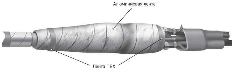
**15.1** Поверх внутреннего кожуха произвести намотку алюминиевой ленты с перехлестом витков 15–20 мм. Намотку необходимо начинать от края малых пружин постоянного давления кабелей с изоляцией из сшитого полиэтилена и закончить на металлической оболочке маслопропитанного кабеля с заходом на нее на 20 мм. Концы алюминиевой ленты зафиксировать изоляционной лентой ПВХ.
