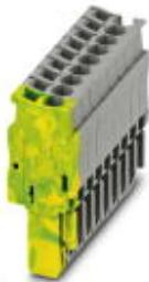
Штекер, номинальное напряжение: 500 В, номинальный ток: 24 А, тип подключения: Пружинный зажим, Штекерное подключение, количество точек подсоединения: 9, полюсов: 9, сечение: 0,08 мм<sup>2</sup> - 4 мм<sup>2</sup>, AWG: 28 - 12, ширина: 46,8 мм, высота: 39 мм, цвет: серый
