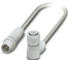
Кабель для датчика / исполнительного элемента, 4-полюсн., PP-EPDM без галогенов, серый RAL 7035, Штекеры прямое M12, А-кодирование, к Гнездо угловой M12, А-кодирование, с 3 светодиода, длина кабеля: 3 м, Гигиеничный дизайн, с пластмассовой накатанной гайкой
