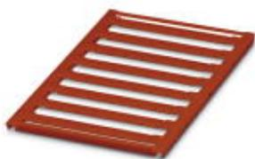
Маркировка для клеммных модулей, Пластина, красный, без маркировки, маркируется с помощью: BLUEMARK ID COLOR, BLUEMARK ID, BLUEMARK CLED, PLOTMARK, CMS-P1-PLOTTER, тип монтажа: крепление в плоских пазах для табличек, для клемм шириной: 8,2 мм, размер маркировочного поля: 7,6 x 5,1 мм
