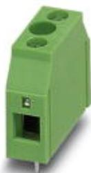
Клеммы для печатной платы, номинальный ток: 41 А, номинальное напряжение: 320 В, размер шага: 7,5 мм, полюсов: 1, тип подключения: Винтовой зажим с натяжной гильзой, монтаж: Пайка волной припоя, направление подключения, проводник/печатная плата: 0 °, цвет: зеленый
