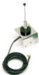
Всенаправленная антенна, 900 МГц, коэффициент усиления: 2 дБи, поляризация: линейная, угол раскрытия: h 360°, степень защиты: IP65, разъем: MCX (штыревой), вкл. кабель 2 м и уголок для настенного монтажа
