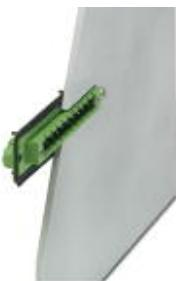
Компоненты для проходного монтажа, номинальный ток: 12 А, расчетное напряжение (III/2): 320 В, полюсов: 9, размер шага: 5,08 мм, цвет: зеленый, поверхность контакта: олово, монтаж: Пайка волной припоя
