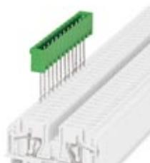
Корпусная часть для печатных плат, номинальный ток: 12 A, расчетное напряжение (III/2): 320 В, полюсов: 12, размер шага: 5,08 мм, цвет: зеленый, поверхность контакта: олово, монтаж: Монтажная рейка
