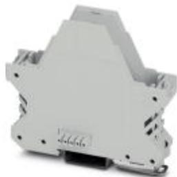
Установочный корпус, длина: 99 мм, с вентиляционными отверстиями, Нижняя часть корпуса, поперечное соединение: встроенный шинный соединитель, цвет: светло-серый, ширина: 22,5 мм, высота: 92 мм, кол-во контактов поперечного соединителя: 5
