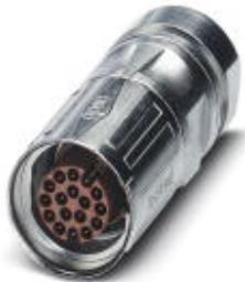
Кабельный соединитель, прямой, Крепление SPEEDCON, M17, полюсов: 8, тип контактов: Штифт, Обжим, экранирован.: есть, диапазон диаметра кабеля: 5 мм ... 8 мм
