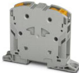
Клемма для высокого тока, номинальное напряжение: 1000 В AC / 1500 В DC, номинальный ток: 150 А, тип подключения: Зажим Power-Turn, количество точек подсоединения: 2, полюсов: 1, сечение: 10 мм<sup>2</sup> - 70 мм<sup>2</sup>, AWG: 8 - 2/0, ширина: 20 мм, высота: 96 мм, цвет: серый, тип монтажа: непосредственное резьбовое
