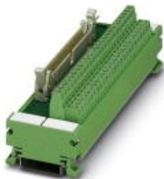
Модуль VARIOFACE с винтовыми клеммами и разъемом для плоского кабеля, устанавливается на монтажную рейку NS 35/7,5, количество контактов 20
