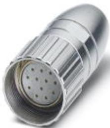
Кабельный соединитель, прямой, экранирован.: есть, Винтовой зажим, M23, Полюсов: 6, тип контактов: Розетка, Подключение пайкой, диапазон диаметра кабеля: 5,5 мм ... 6,5 мм
