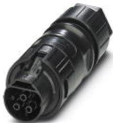
Круглые разъемы (со стороны кабеля), Переходные соединители, конструкция: Разблокировка только при помощи инструмента, материал корпуса: PPE, цвет: черный, полюсов: 3, сечение жилы мин.: 1,5 мм<sup>2</sup>, сечение жилы макс.: 6 мм<sup>2</sup>, номинальное напряжение: 690 V AC, расчетный ток: 35 A, Тип подключения: Винтовые зажимы, Тип контактов: Розетка, мин. диаметр кабеля: 12 мм, макс. диаметр кабеля: 21 мм
