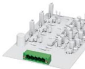
Корпусная часть для печатных плат, номинальный ток: 12 А, расчетное напряжение (III/2): 320 В, полюсов: 5, размер шага: 5,08 мм, цвет: агатовый серый, поверхность контакта: Золото, монтаж: Пайка волной припоя, Позолоченные контакты / цвет: серый RAL 7038
