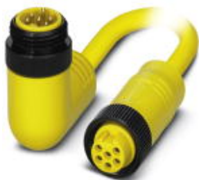
Силовой кабель, 6-полюсн., ПВХ, желтый, Штекеры угловой 7/8"-16UNF, к Гнездо прямое 7/8"-16UNF, длина кабеля: 5 м
