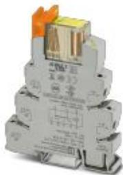
Релейная система PLC-INTERFACE, состоящая из базового модуля и вставного реле защиты с принудительно управляемыми контактами согласно DIN EN 50205, Винтовые зажимы, 2х переключающих контакта, с принудительным размыканием, Входное напряжение: 24 В DC
