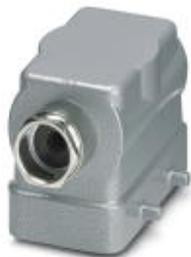
Сальниковый корпус HEAVYCON B10, для крепления двумя защелками, высота 56 мм, с резьбой 1x Pg16, боковой ввод кабеля
