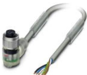
Кабель для датчика / исполнительного элемента, 5-полюсн., PUR без галогенов, стойкий к воздействию искр при сварке, повышенная гибкость, серый RAL 7001, свободный конец, к Гнездо угловой M12, А-кодирование, с 3 светодиода, длина кабеля: 1,5 м, для использования на роботах и тяговых цепях
