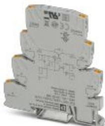
PLC-INTERFACE с контактом обратной связи, состоит из основной клеммы с зажимом push-in и интегрированным миниатюрным полупроводниковым реле, для монтажной рейки NS 35/7,5, 1 замыкающий контакт, вход: 24 В DC, выход: 3-33 В DC/10 А
