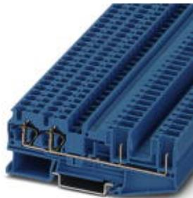
Проходные клеммы, номинальное напряжение: 800 В, номинальный ток: 32 А, тип подключения: Штекерное соединение / пружинный зажим, количество точек подсоединения: 4, сечение: 0,08 мм<sup>2</sup> - 6 мм<sup>2</sup>, AWG: 28 - 10, ширина: 6,2 мм, цвет: синий, тип монтажа: NS 35/7,5, NS 35/15
