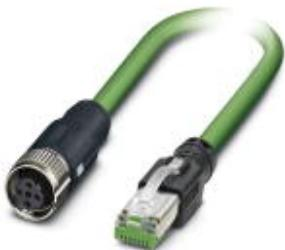
Сетевой кабель, PROFINET CAT5 (100 Мбит/с), EtherCAT® CAT5 (100 Мбит/с), 4-полюсн., ПВХ/ПВХ, зеленый RAL 6018, экранирован., Штекеры прямое RJ45 / IP20, к гнездо прямое M12 SPEEDCON / IP67, механические ключи: D, длина кабеля: 5 м
