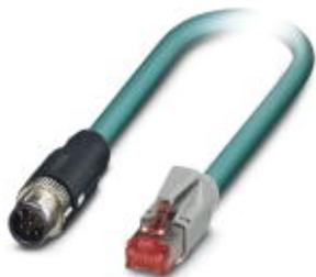
Сетевой кабель, Ethernet CAT5 (1 Гбит/с), 8-полюсн., PUR без галогенов, цвет морской воды RAL 5021, экранирован., Штекеры прямое M12 SPEEDCON / IP67, механические ключи: A, к Штекеры прямое RJ45 / IP20, длина кабеля: 5 м
