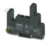
Релейный блок ECOR-1..., для миниатюрных силовых реле или миниатюрных реле с 1 или 2 перекл. контактами, винтовой зажим, возможность установки входных модулей/модулей подавления помех, для монтажа на NS 35/7,5
