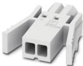
Разъемы для печатной платы, номинальный ток: 6 А, расчетное напряжение (III/2): 160 В, полюсов: 2, размер шага: 2,5 мм, тип подключения: Обжим, цвет: белый
