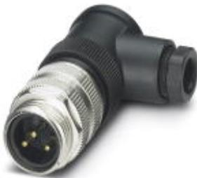
Разъем, 3-полюсн., Штекеры угловой 7/8"-16UNF, Винтовые зажимы, материал накатанной гайки: Цинк. литья под давлением, с никелевым покрытием, кабельный ввод Pg9, наружный диаметр кабеля 6 мм ... 8 мм, Контакт 1 опережающий
