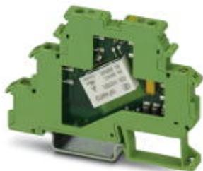
Релейный клеммный модуль со впаянными миниатюрными реле, материал контактов AgNi+Au: для коммутации нагрузок от малых до средних, 1 замыкающий контакт, входное напряжение 24 В AC/DC, монтируется на NS 35/7.5, ширина клеммного модуля 6,2 мм
