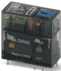
Вставное миниатюрное реле, с многослойным контактом и дополнительным твердым позолоченным покрытием, 2 переключающих контакта, кнопка для тестирования, механический индикатор коммутационного положения, статусный светодиод, диод свободного хода, полярность A1+, A2-, входное напряжение 24 В DC
