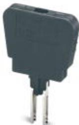
Штекерный держатель предохранителя, с индикатором для 30-60 В AC/DC, тип предохранителя: Стекло / керамика / ..., полюсов: 1, тип подключения: Штекерное подключение, номинальный ток: 6,3 А, номинальное напряжение: 60 В, ширина: 6,1 мм, тип предохранителей: G / 5 x 20, цвет: темно-серая
