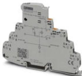
Устройство защиты от перенапряжений, со встроенным индикатором состояния и ножевыми размыкателями для 2-проводной сигнальной цепи без потенциала земли, например токовых контуров 0(4)...20 mA. Непрямое заземление через газовый разрядник.
