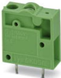
Клеммы для печатной платы, номинальный ток: 24 A, номинальное напряжение: 630 В, размер шага: 7,5 мм, полюсов: 2, тип подключения: Винтовой зажим с натяжной гильзой, монтаж: Пайка волной припоя, направление подключения, проводник/печатная плата: 0 °, цвет: зеленый
