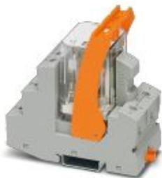
Смонтированный релейный модуль с винтовым зажимом: цоколь реле, реле с силовыми контактами и поддерживающая скоба. Исполнение контактов: 3 замыкающих. Входное напряжение: 24 В пост. тока
